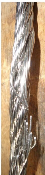
Particolare fune dopo l'estrazione dal morsetto, dopo la prova
