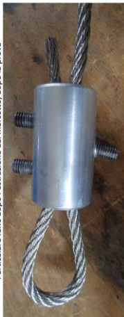
Particolare morsetto dopo la prova (grani svitati manualmente)
